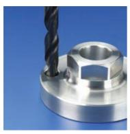
1) Bohren Sie das Loch mit einem Standardbohrer ø entsprechend der Tabelle und einem Spitzenwinkel von 100-1200 (900 Spitzenwinkel für Miniatureinsätze).
