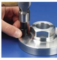
4) Treiben Sie die Sperrkeile mit einigen Hammerschlägen auf das Installationswerkzeug ein.
