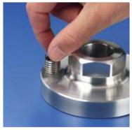
3) Schrauben Sie den K-Sert ein bis er ca. 0,25-0,70 mm unter der Oberfläche ist. Die Sperrkeile zeigen die richtige Tiefe an.
